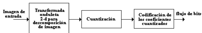
Figura 1.- Diagrama de bloques de la codificación de imagen con la transformada onduleta
